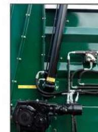
REDUTOR/ CILINDRO HIDRÁULICO/ VÁLVULA REGULAGEM DA ESTEIRA
