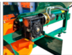
REDUTOR DA ESTEIRA COM ACIONAMENTO HIDRÁULICO
